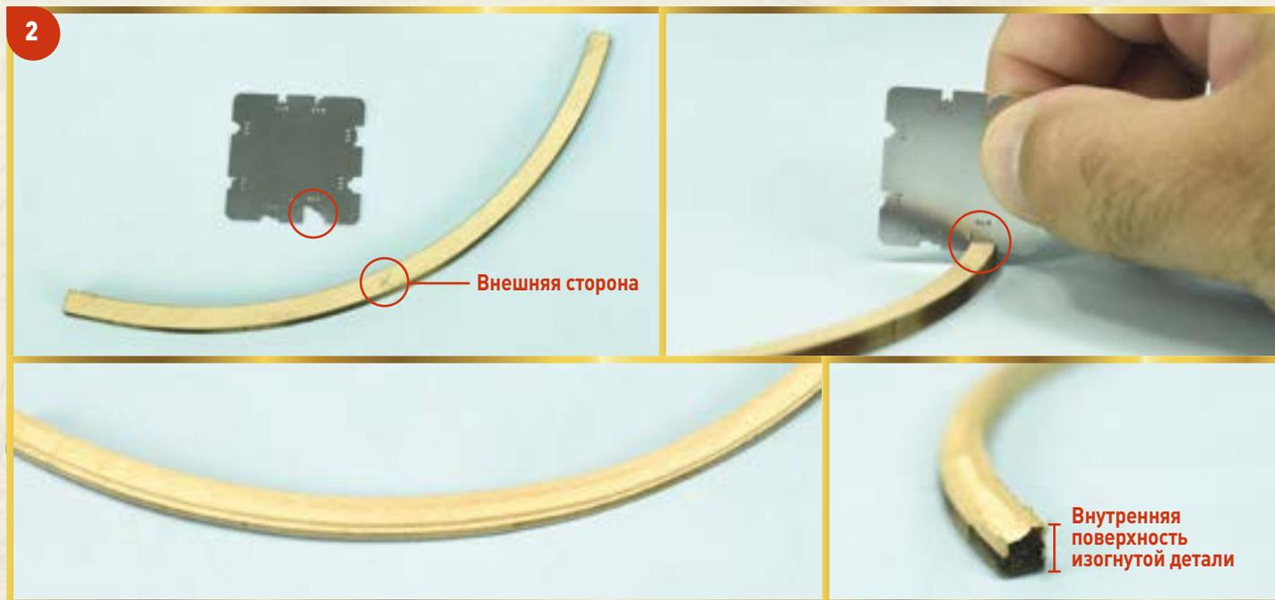
**2** Теперь вам предстоит обработать внешнюю сторону детали QRCM2 фигурной циклей. Используйте профиль 5 x 4, расположив его так, чтобы заглабленная часть профиля находилась со стороны внутреннего изгиба детали QRCM2 (см. фотографии). Затем слегка обработайте деталь наждачной бумагой.
