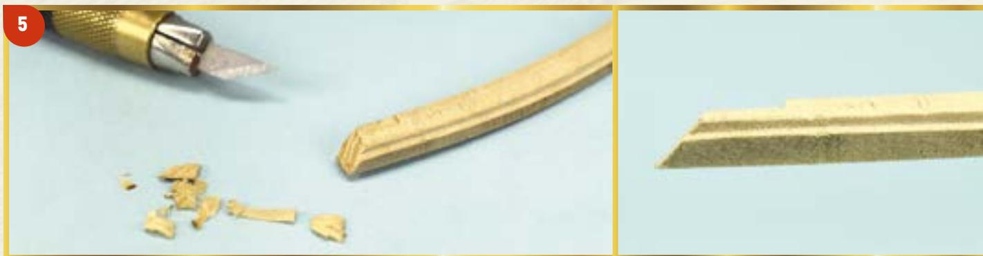
**5** Обрежьте ножом под углом  $45^\circ$  нижний конец детали QRCM2, чтобы он без зазоров примыкал к детали QRCM1.
