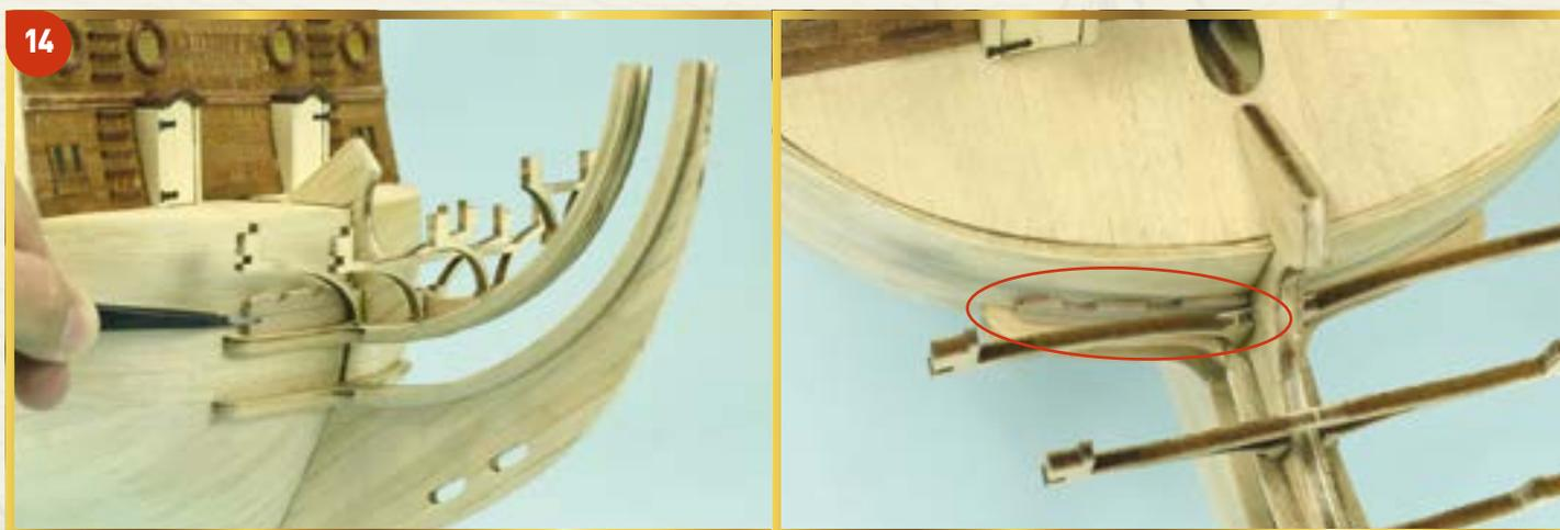
**14** Одну из изготовленных в предыдущем шаге деталей слегка изогните, чтобы она соответствовала изгибу корпуса. Далее приклейте эту деталь над правой верхней чиксой, расположив ее так, как показано на фотографиях.
